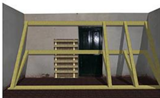
A1. Continuar retirando el acabado del muro en sentido horizontal mediante puntero hasta llegar al pie derecho inmediatamente continuo al afectado. (se recomienda primero marcar la zona de intervención con el puntero de manera cuidadosa)
