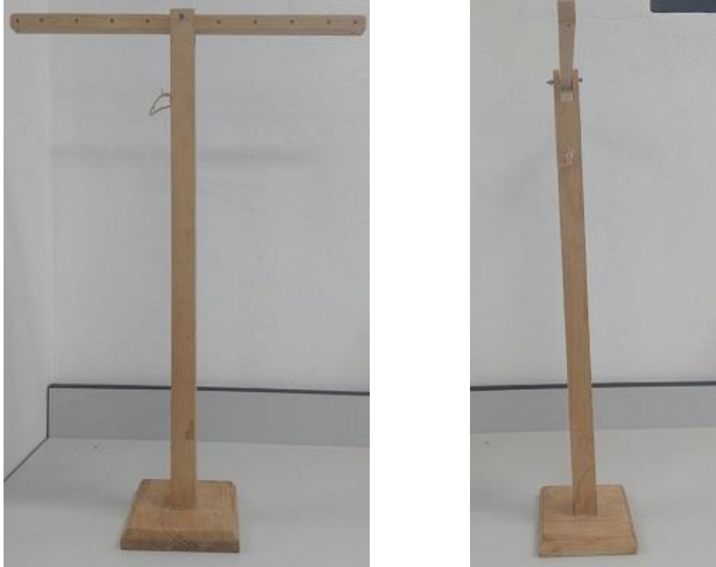
Figura 6. Prototipo experimental didáctico para la comprobación de la Segunda Condición de Equilibrio
