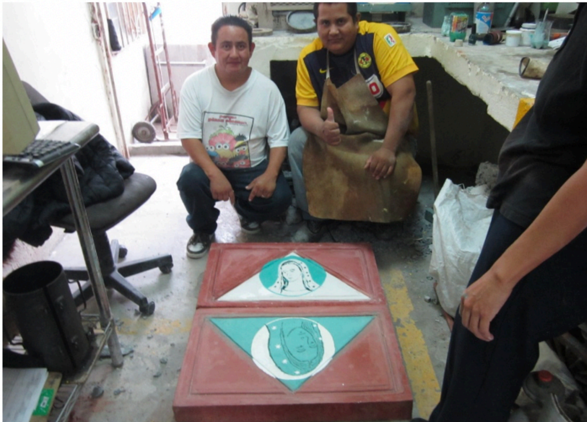
Fig. 16.-Banqueta hecha de 2 planchas de concreto con cementos ecológicos. Inspirada en la bandera mexicana
