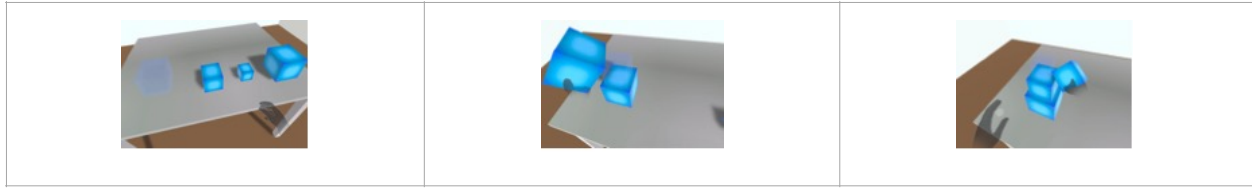
Figura 3. Prototipado con polígonos simples para definir las áreas de interacción y creación de ayudas visuales que guían al usuario a colocar la pieza esperada y en la posición deseada.
