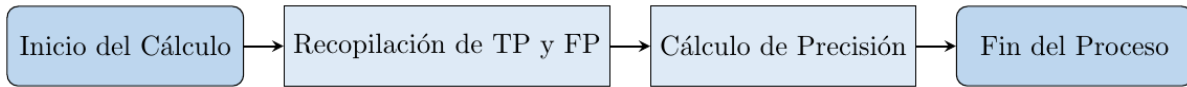
Ilustración 32 - Diagrama de Flujo del Cálculo de la Precisión en Modelos de Visión por Computadora. (Fuente: Propia)
