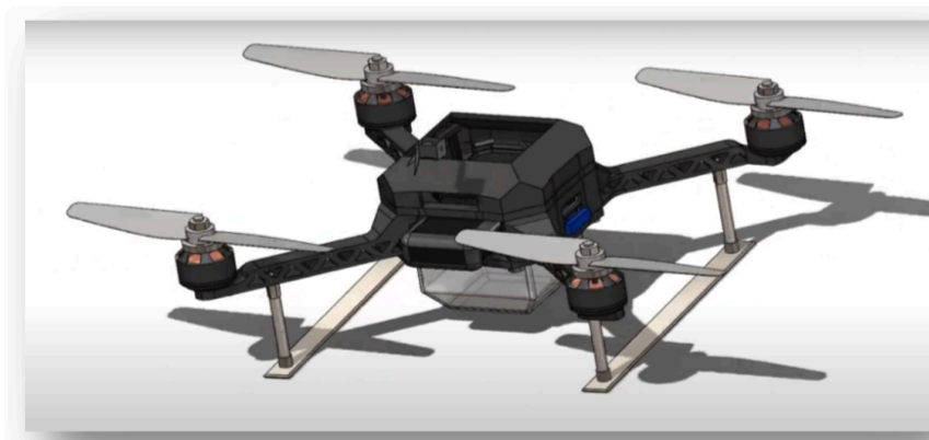
Imagen #8. Prototipo del dron utilizado en el Cacao diseñado en SolidWorks. Fuente: Propia.
